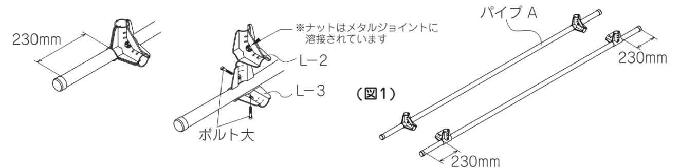
2. 1.で作ったものにメタルジョイント L-1を2個組み合わせて下記の寸法で(図2)のように取り付けます。メタルジョイントの向きを揃えてメタルジョイントが動かない程度にボルト大とナットで仮止めをしてください。
